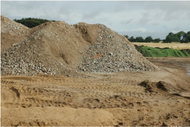
Sorteret byggeaffald, såsom beton og tegl efter knusning
